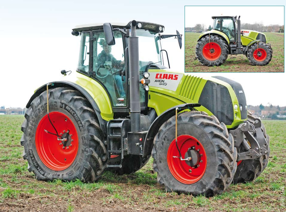
Nachgerüsteter Reifenregler der Fa. Strotmann am Claas Axion. Im Bild oben rechts für bessere Seitenführung, hohe Last und Geschwindigkeit auf Straßendruck mit 1,5 bar eingestellt. Mit dem vom Reifenhersteller empfohlenen Druck im Radialreifen, hier 0,6 bar (großes Bild), wird die Spur flacher, der Boden geschützt und Fahrer und Maschine durch besseren Fahrkomfort geschont.
