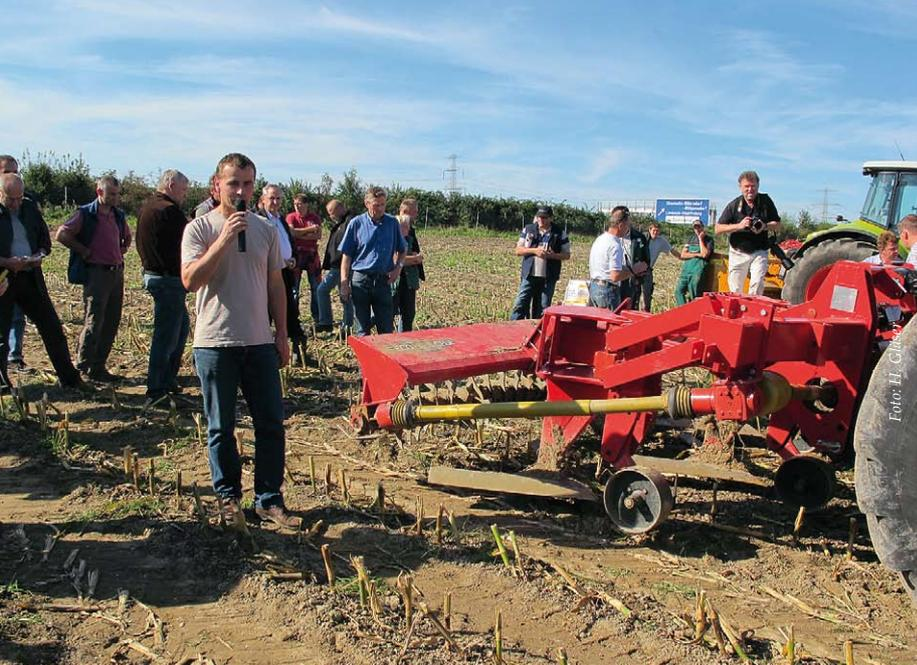
*Der Maiszünsler überdauert in den Maisstoppeln, Fusarium entwickelt sich auf dem Maisstroh. Um diesen Problemen vorzubeugen, sollten die Maisrückstände fein zerkleinert und flach in den Boden eingearbeitet werden. Neben den bekannten Schlegel- und Sichelmulchern gibt es jetzt auch neue Geräte wie den Glypho-Mulch, der den Boden flach schält und anschließend mit einer angetriebenen Messerwelle zerkleinert.*
