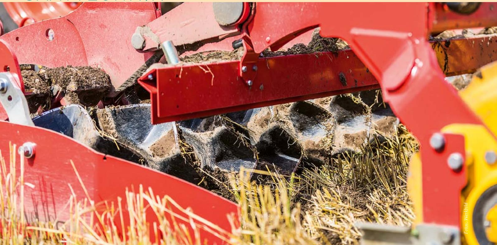
Das Bodenbearbeitungsgerät CrossCutterDisc (CCD) ist sowohl für eine ultraflache Stoppelbereitung vor Zwischenfrüchten wie auch zur Saatbettbereitung für den nachfolgenden Mais geeignet.
