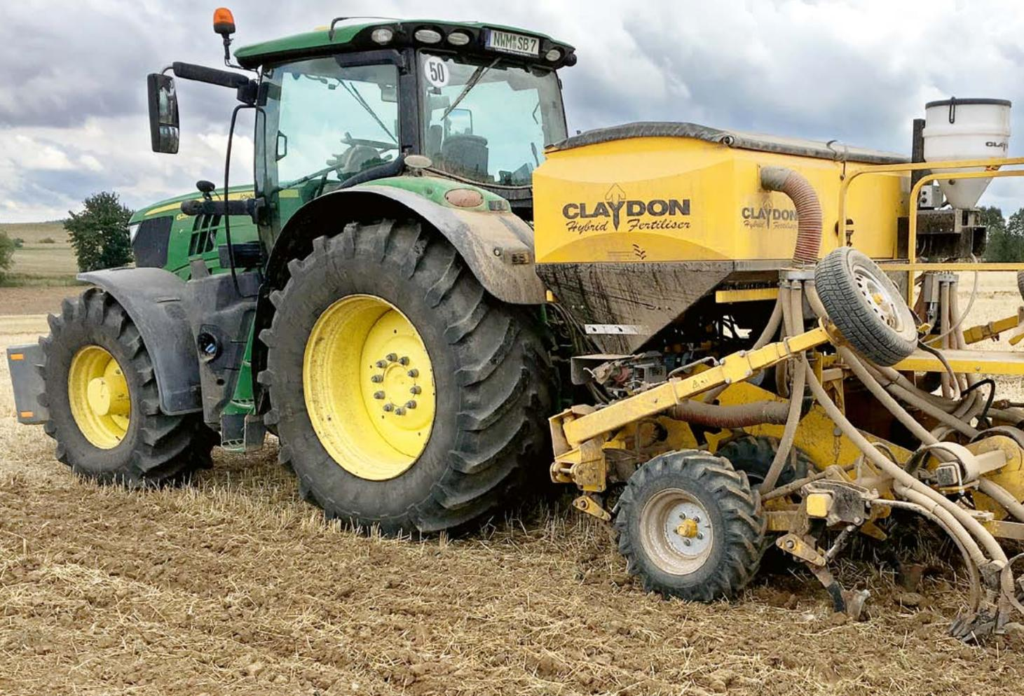
Claydon Hybrid Fertilizer mit 3 m Arbeitsbreite: Neben dem geteilten Haupttank gibt es noch zwei gesonderte Behälter, z. B. für Schneckenkorn und Untersaaten.
