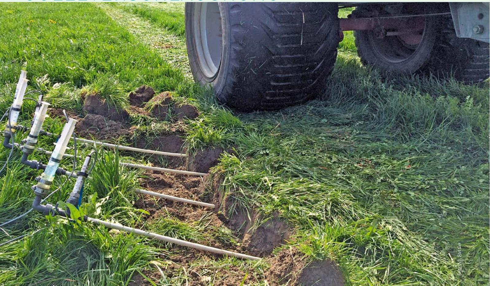
Bodendruckmessung in zwei Tiefen mit Bolling-Sonden.
