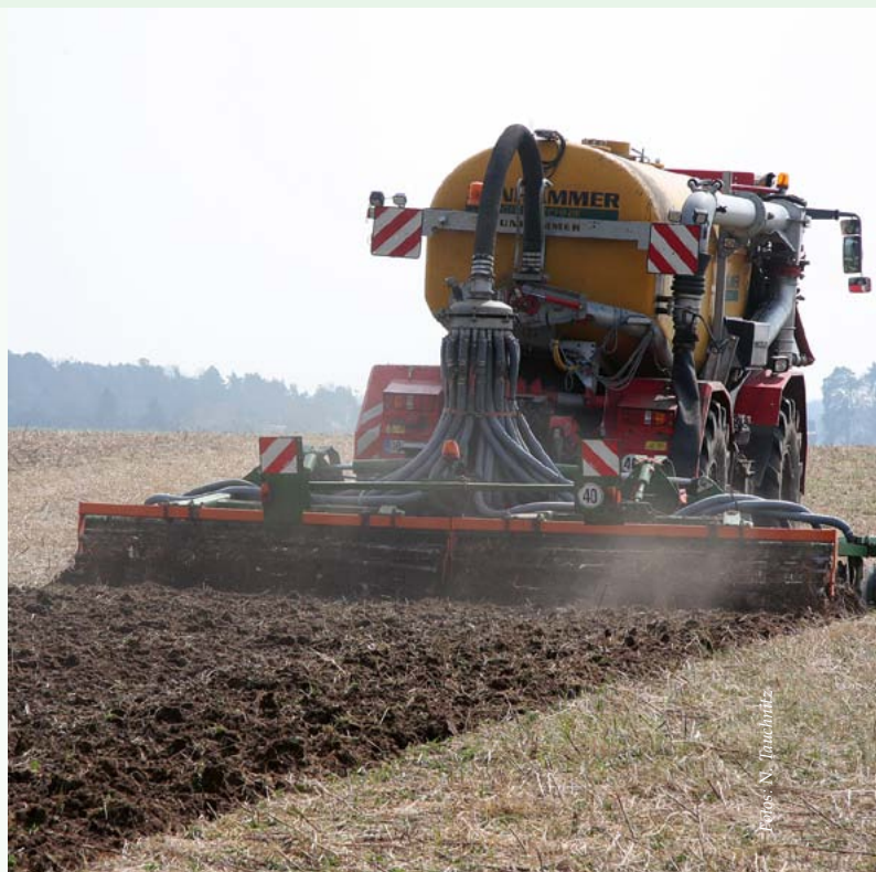
Bild 1: Gülle-Ausbringung mittels Gülle-Strip-Till (links) sowie ganzflächige Ausbringung und sofortige Einarbeitung der Gülle (rechts) im Parzellenversuch in Lückstedt
