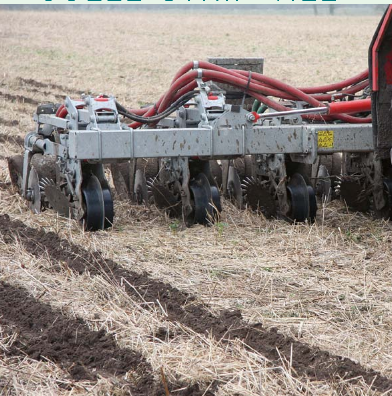
Bild 1: Gülle-Ausbringung mittels Gülle-Strip-Till (links) sowie ganzflächige Ausbringung und sofortige Einarbeitung der Gülle (rechts) im Parzellenversuch in Lückstedt
