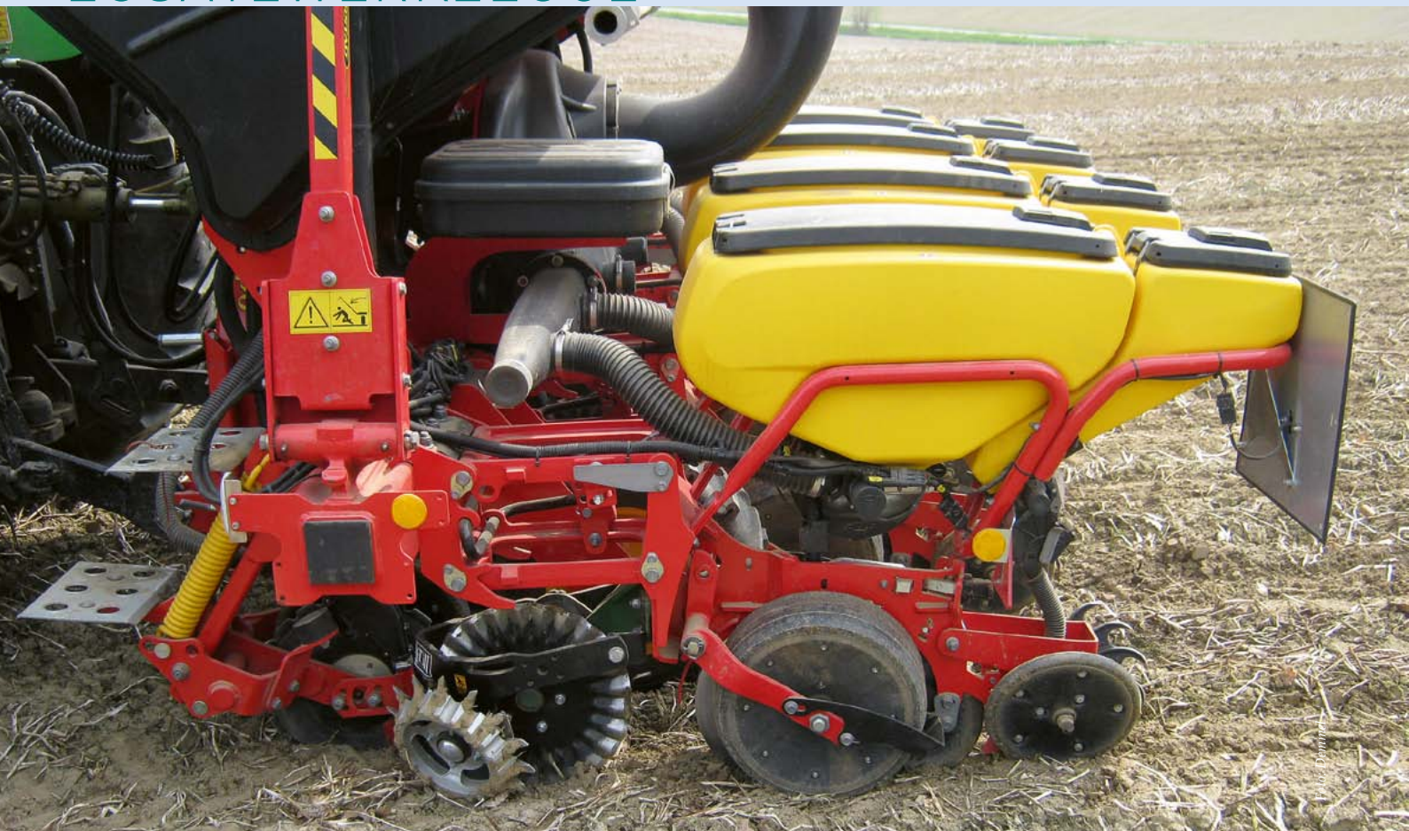
Bild 1: Zusatzausrüstungen an der Einzelkornsämaschine sollen die Tauglichkeit für die Mulch- und Direktsaat verbessern: Vorn eine Kombination aus Wellsech mit Räumsternen, hinten Curvetine-Andruckrolle.
