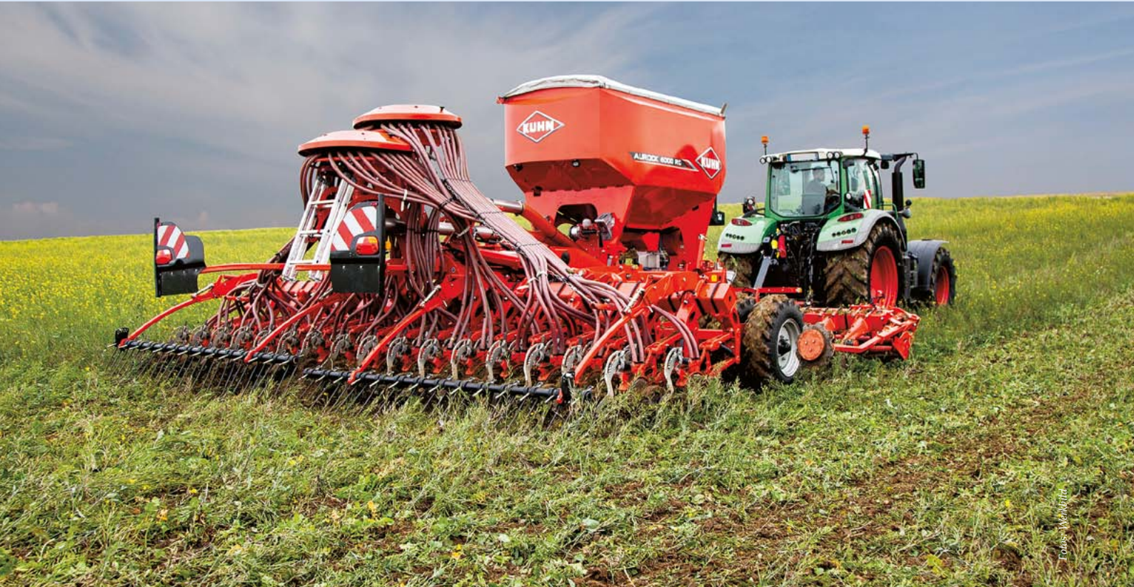
Dreischeiben-Direktsaatmaschine Kuhn Aurock bei der Einsaat von Getreide in einen stehenden Zwischenfruchtbestand.
