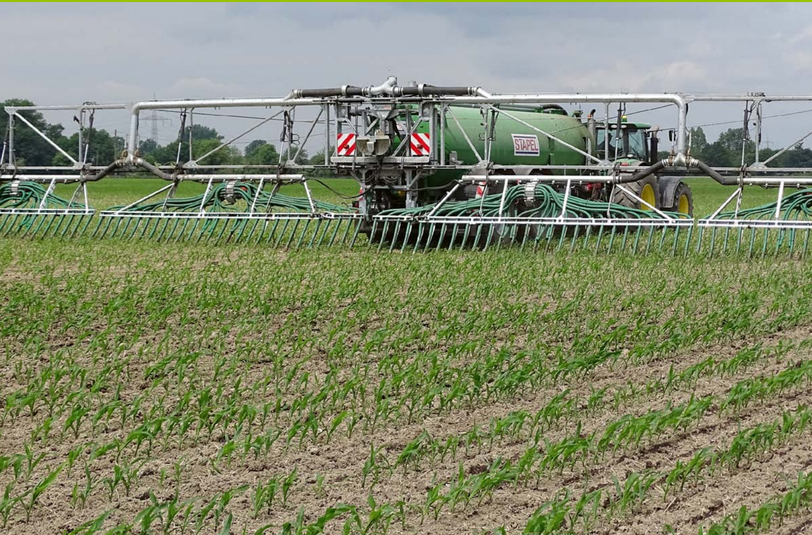
Gülleausbringung mit Stapel-Güllefass und 27 m Stapel-Schleppschuhgestänge in einen stehenden Maisbestand.
