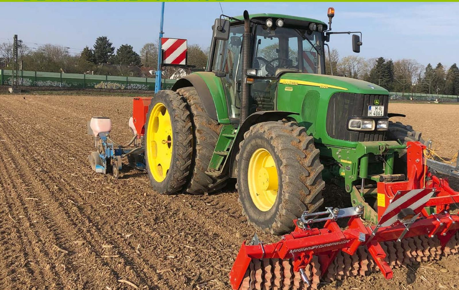
Mulchsaat von Mais mit einer Prismenwalze im Frontanbau, im Heck eine Einzelkornsämaschine von Monosem mit Schneidscheiben.
