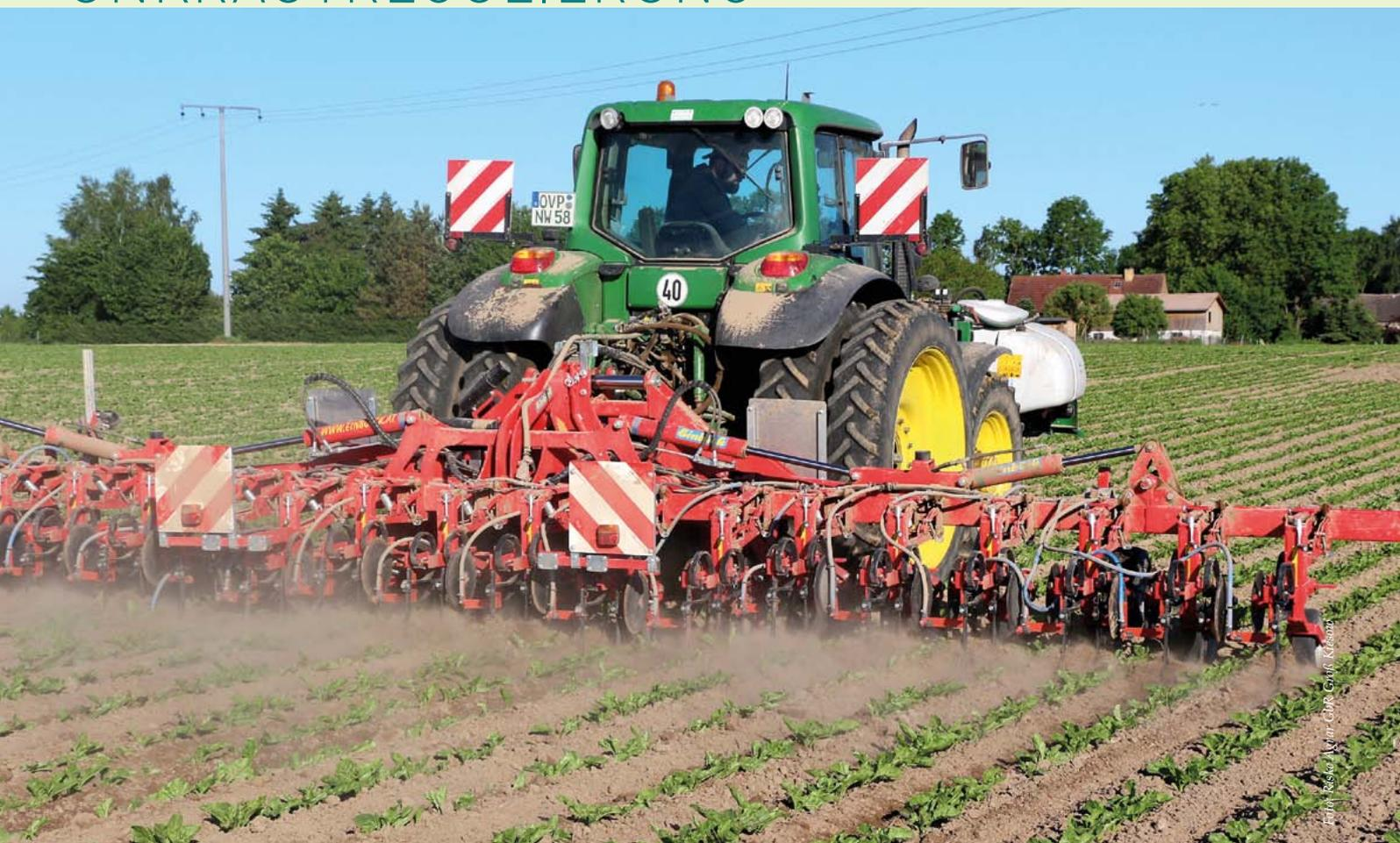
Hacken von Zuckerrüben in Verbindung mit einer Bandspritzung.
