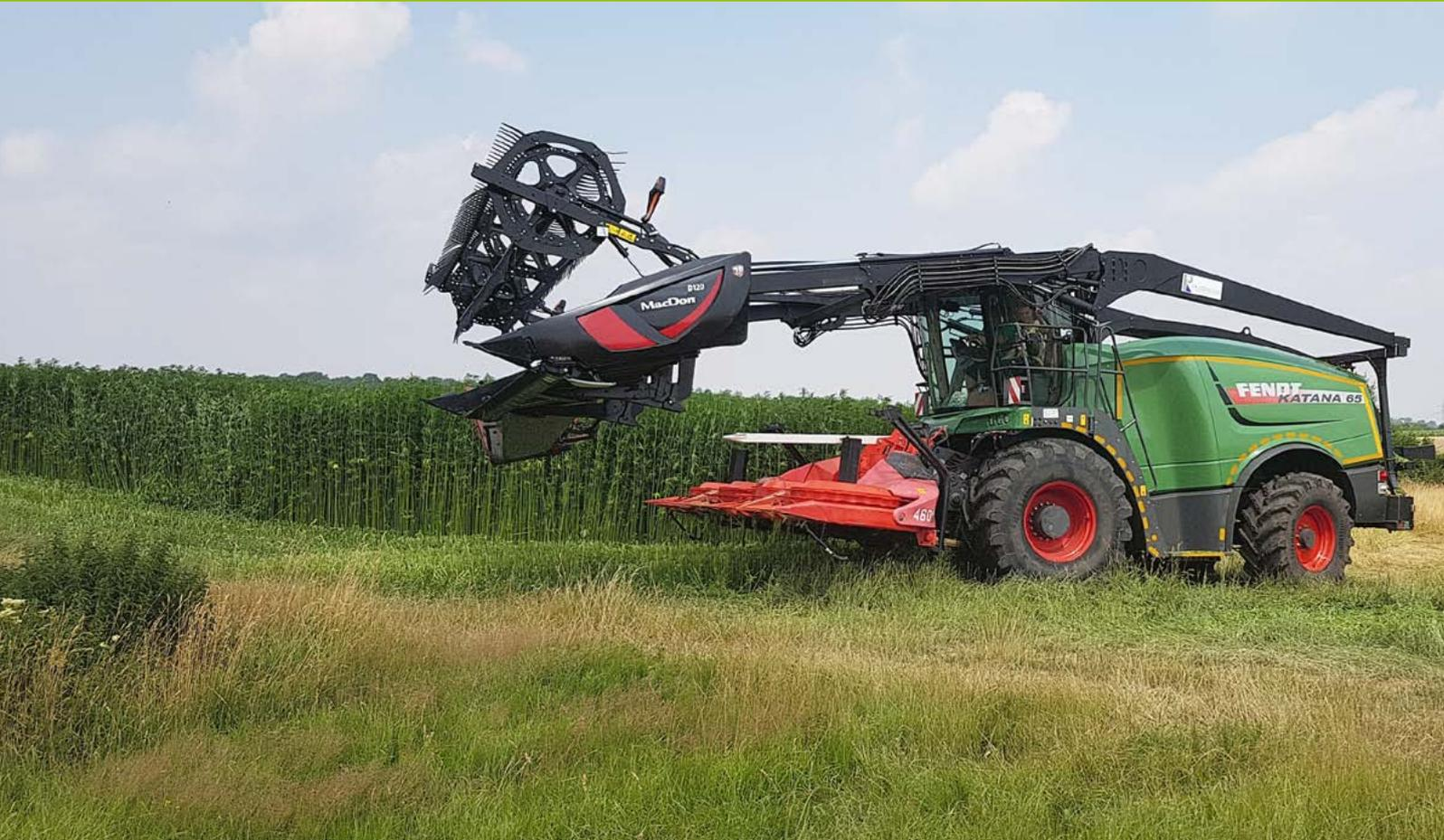
Zur Ernte des Hanfes wird Spezialtechnik benötigt, z. B. ein modifizierter Feldhäcksler Fendt Katana.
