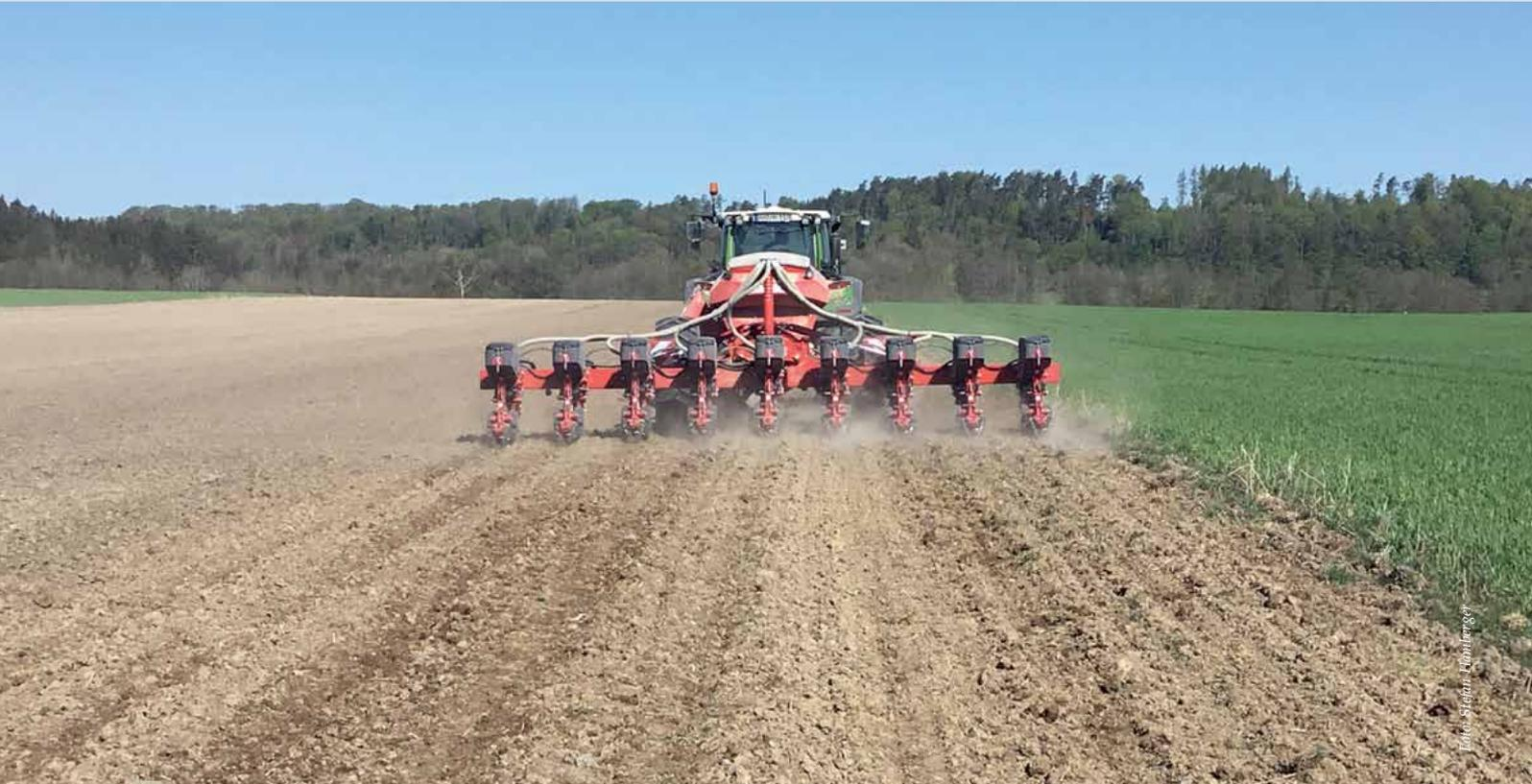
Moderne Einzelkornsämaschinen bieten zahlreiche Innovationen, wie Section Control, teilflächenspezifische Saat nach Applikationskarten oder die Dosierung von Mikrogranulaten.
