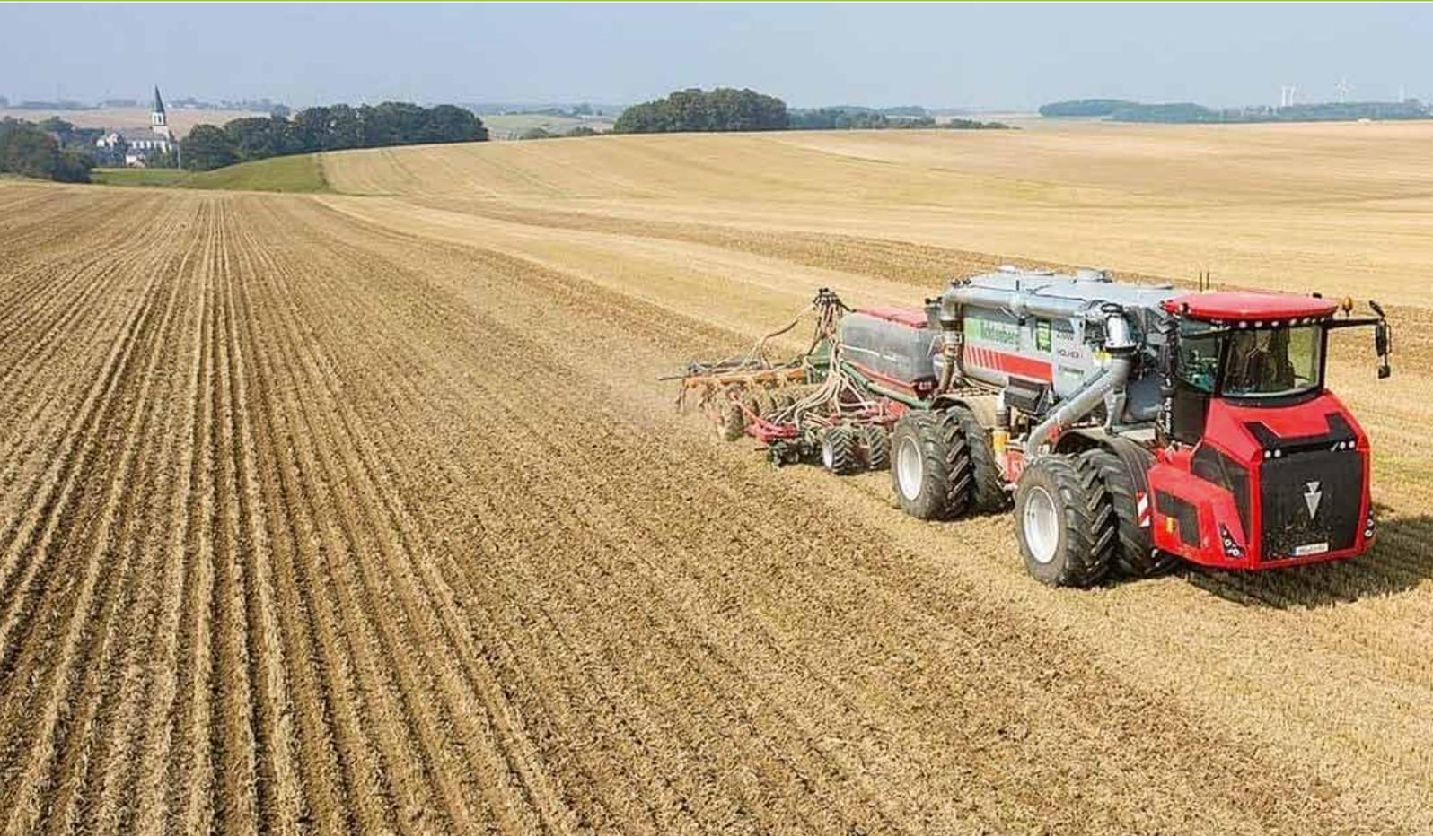
Gülle-Strip-Till bei Rapsaussaart mit dem Holmer Terra Variant 650 stufenlos.
