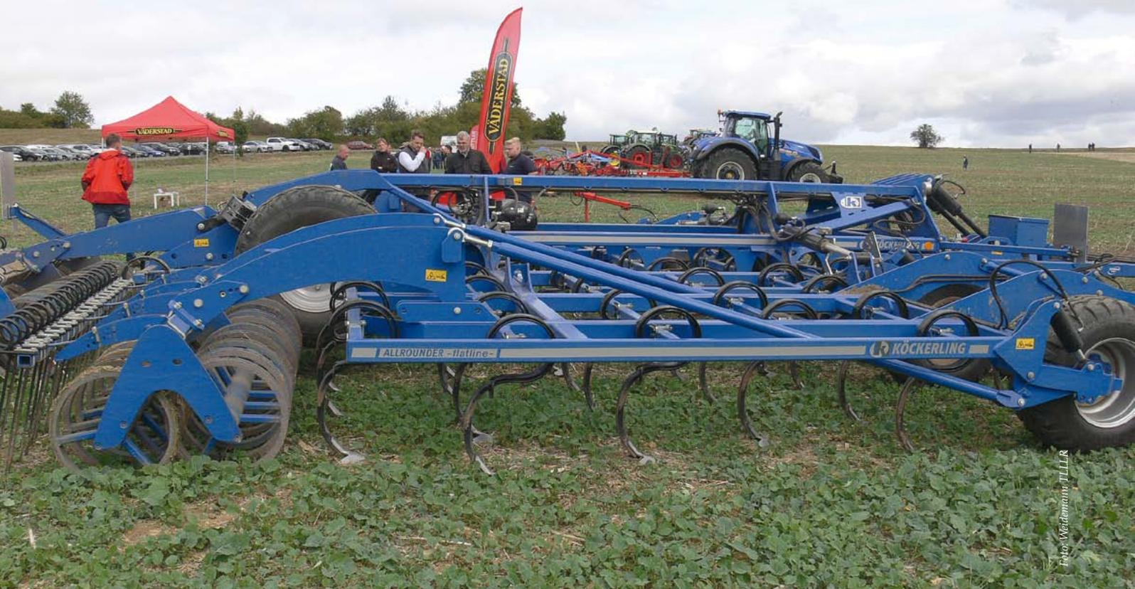
Grubber mit guter Tiefenführung und breiten Gänsefußscharen wie der Köckerling Allrounder flatline erreichten hohe Wirkungsgrade bei der Bekämpfung von Ausfallraps.
