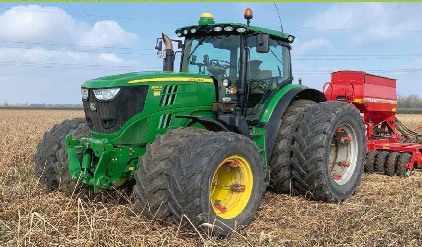
Mit Zwillingsbereifung und Reifendruckregelanlage wird der Bodendruck auf den Minutböden deutlich reduziert.
