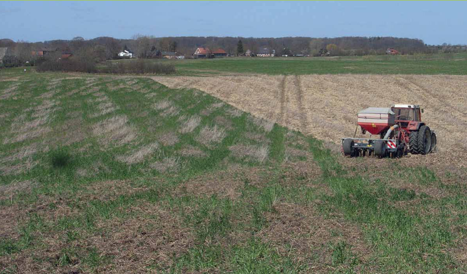
Direktsaat in die unbearbeitete Stoppel mit der Moore Unidrill-Scheibenscharsämaschine.
