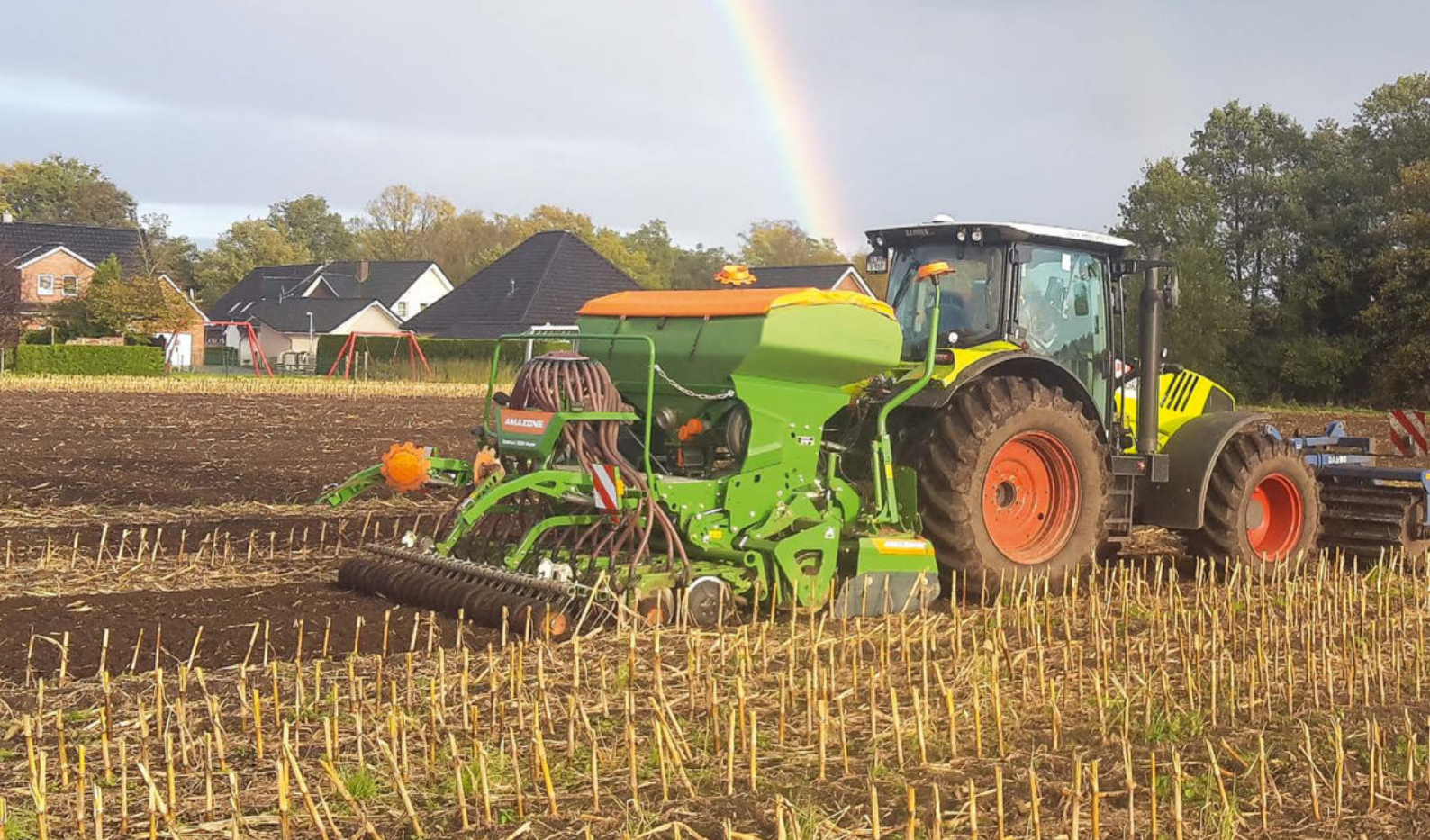
Mulchsaat von Weizen nach Silomais, Messerwalze im Frontanbau.
