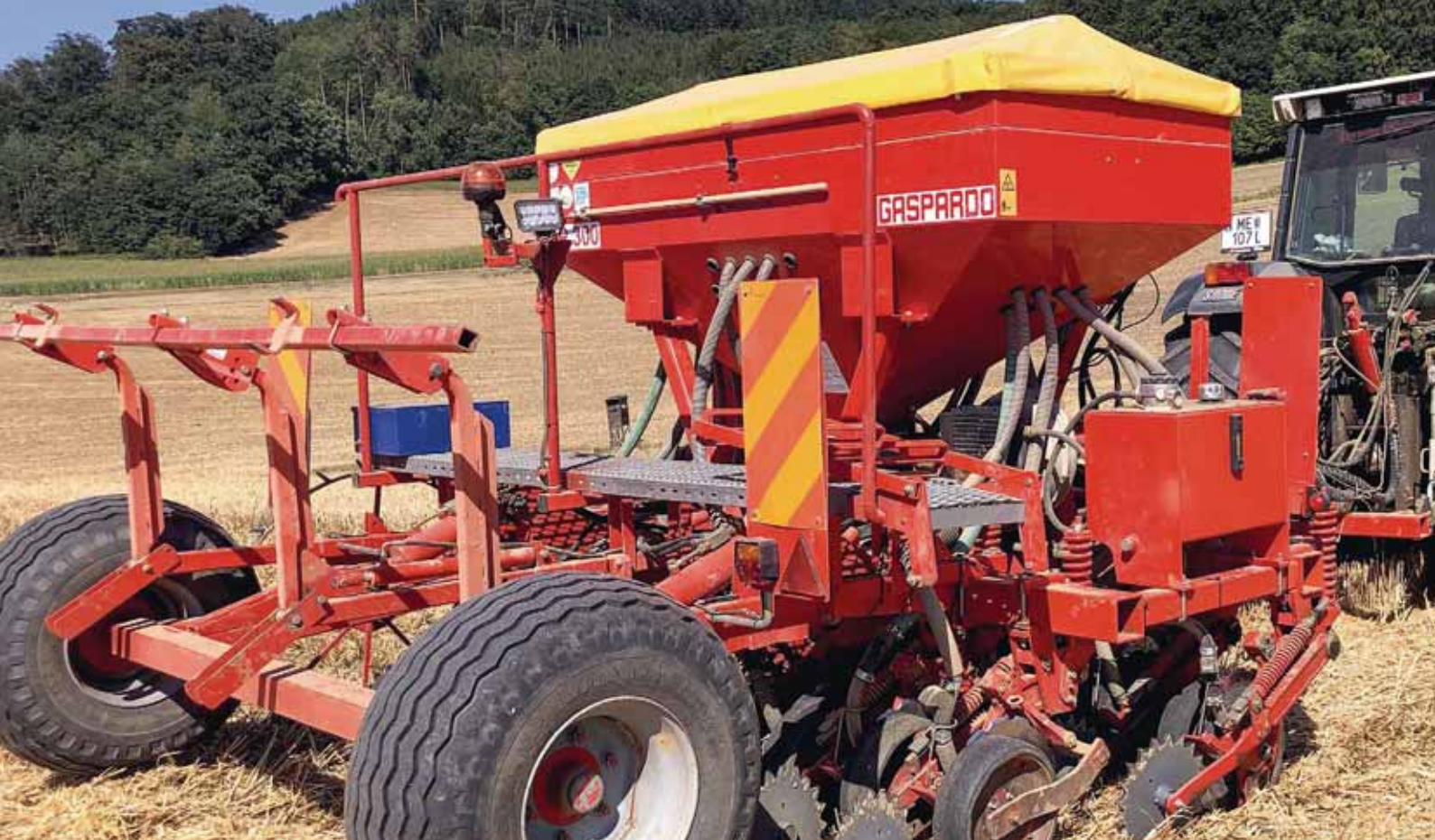
Direktsaatmaschine Gaspardo DP 300 bei der Einsaat von Zwischenfrüchten in die Getreidestoppel.
