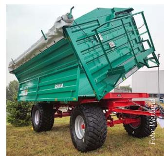
Dazu zählen Pendelbordwände oder eine hydraulische Seitenbordwand, die Auskleidung mit Siebdruckplatten für den Kartoffeltransport oder Zubehöroptionen wie Alu-Schurre, Überladeschnecke, Auslaufutsche, Unterfahrerschutz und anderes mehr. **pi**
