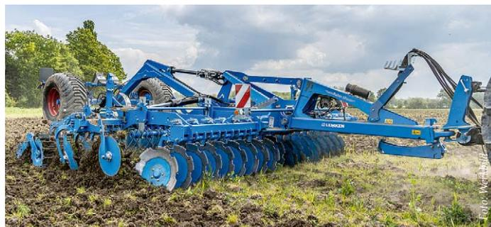
■ Für die aufgesattelte Kurzscheibenegge Lemken Rubin 10 TF, die es von 4 m bis 7 m Arbeitsbreite gibt, werden ab 2025 zahlreiche Neuerungen eingeführt. Der um 150 mm auf 1.350 mm vergrößerte Balkenabstand sorgt dafür, dass sich die organische Masse nach der ersten Scheibenreihe weiter beruhigen kann und somit die Schneid- und Mischwirkung der zweiten Scheibenreihe verbessert wird. Zusätzlich zum bereits bekannten Strohstriegel werden das Planier-
