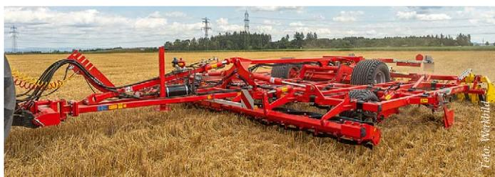
■ Der Landtechnikhersteller Pöttinger erweitert sein Produktprogramm um den gezogenen Flachgrubber Plano VT 6060 mit sechs Meter Arbeitsbreite und sechsbalbigem Aufbau. Bei der Entwicklung wurde das Augenmerk speziell auf das flache und ganzflächige Schneiden gelegt. Ein Strichabstand von nur 16,2 cm sorgt für ein gutes Krümeln, Mischen und Einebnen. Die starren Grubberzinken sind mittels Druckfedern gegen Überbelastung bis 200 kg für ein strichstabiles Arbeiten gesichert. Für ein flaches
