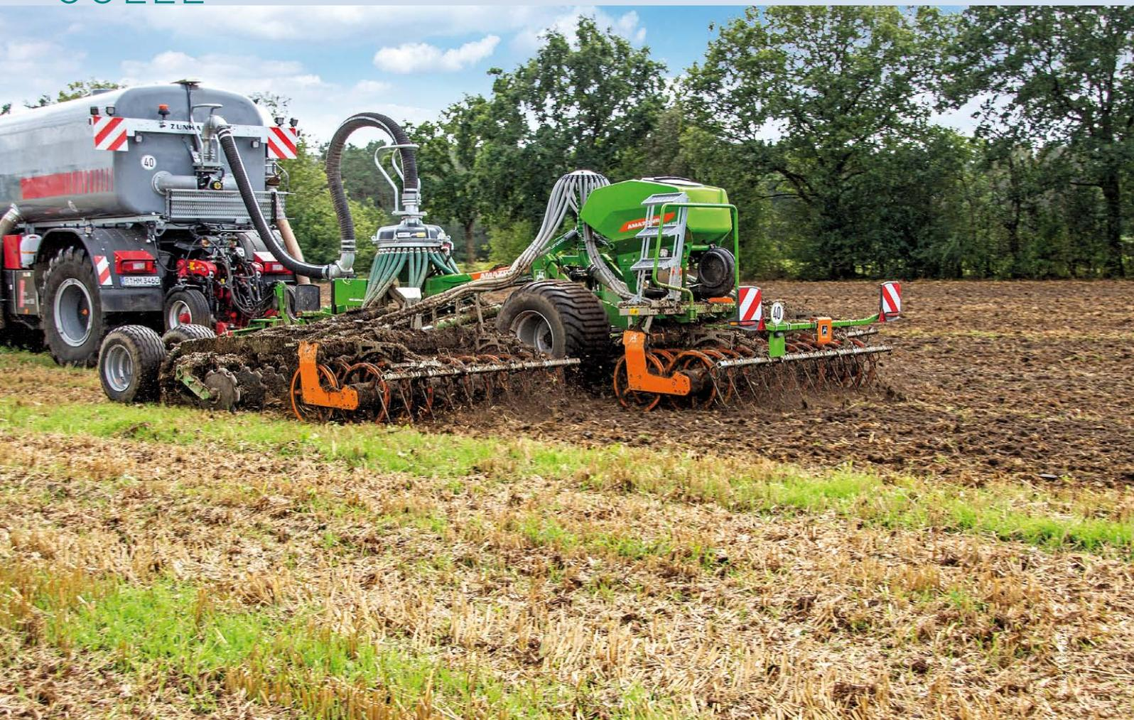
Kurzscheibenegge hinter dem Gülle-Selbstfahrer mit aufgebautem Sägerät für Zwischenfrüchte.
