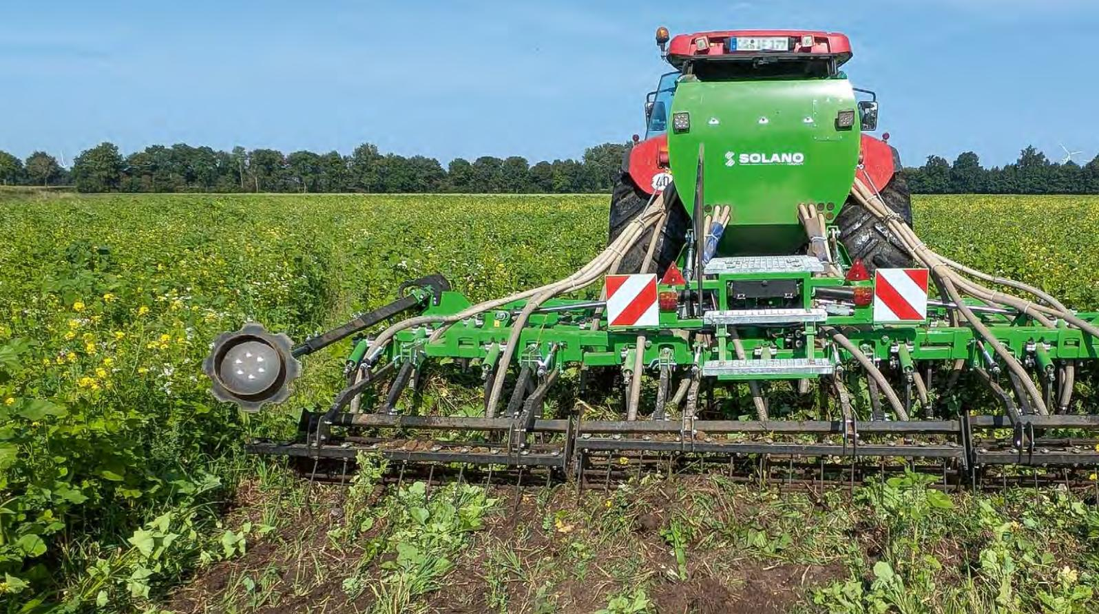
Zinkensämaschine SDR 500 von Solano Horizonte bei „Planting Green“ in die stehende Zwischenfrucht.
