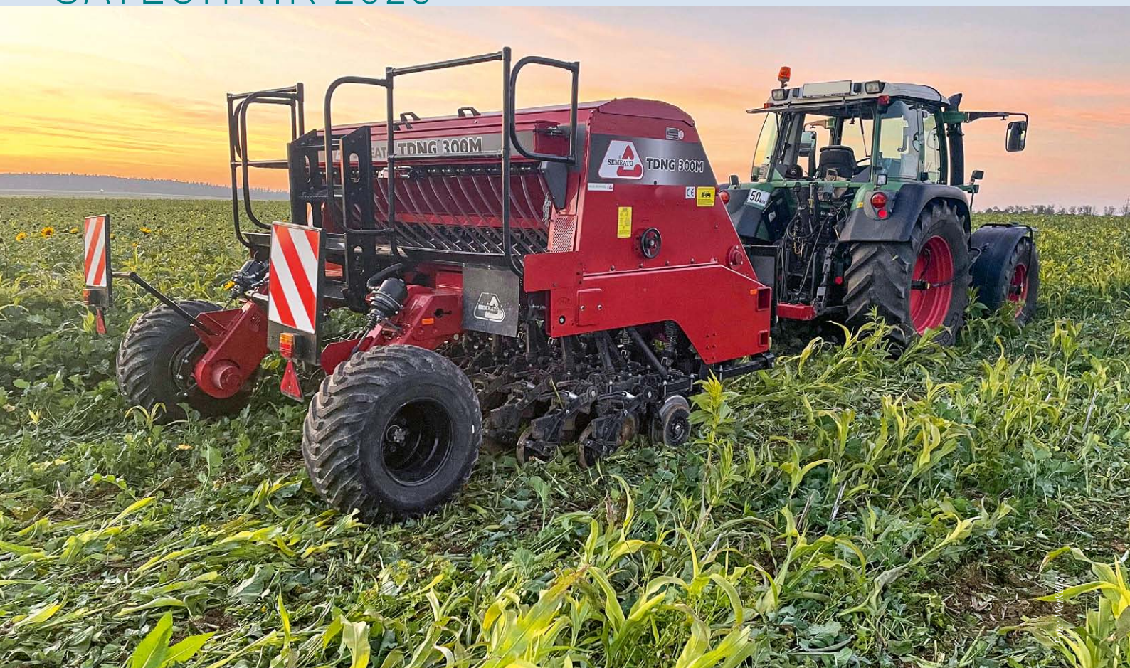
Planting Green mit Scheibenschar-Direktsaatmaschine von Semeato in eine abfrierende Zwischenfrucht.
