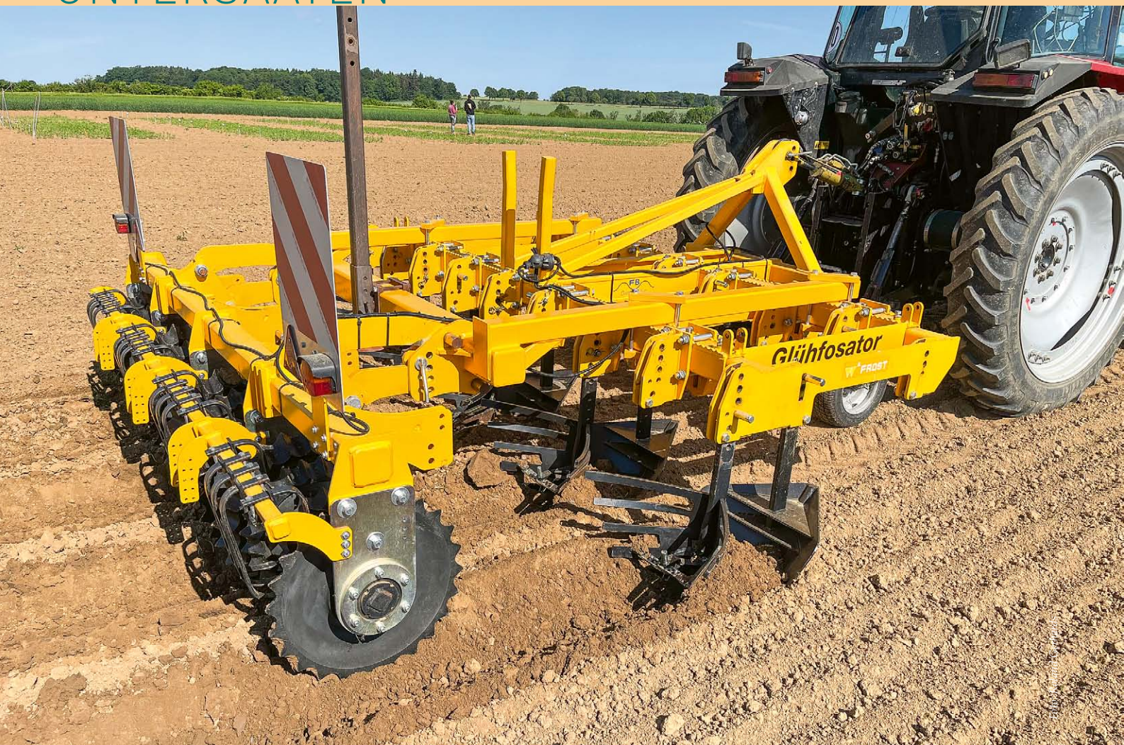
Abb. 1: Dammkulturgerät mit Häufel, Plateauschieber (für Getreide) und Prismenwalzen zum Rückverfestigen der Dämme
