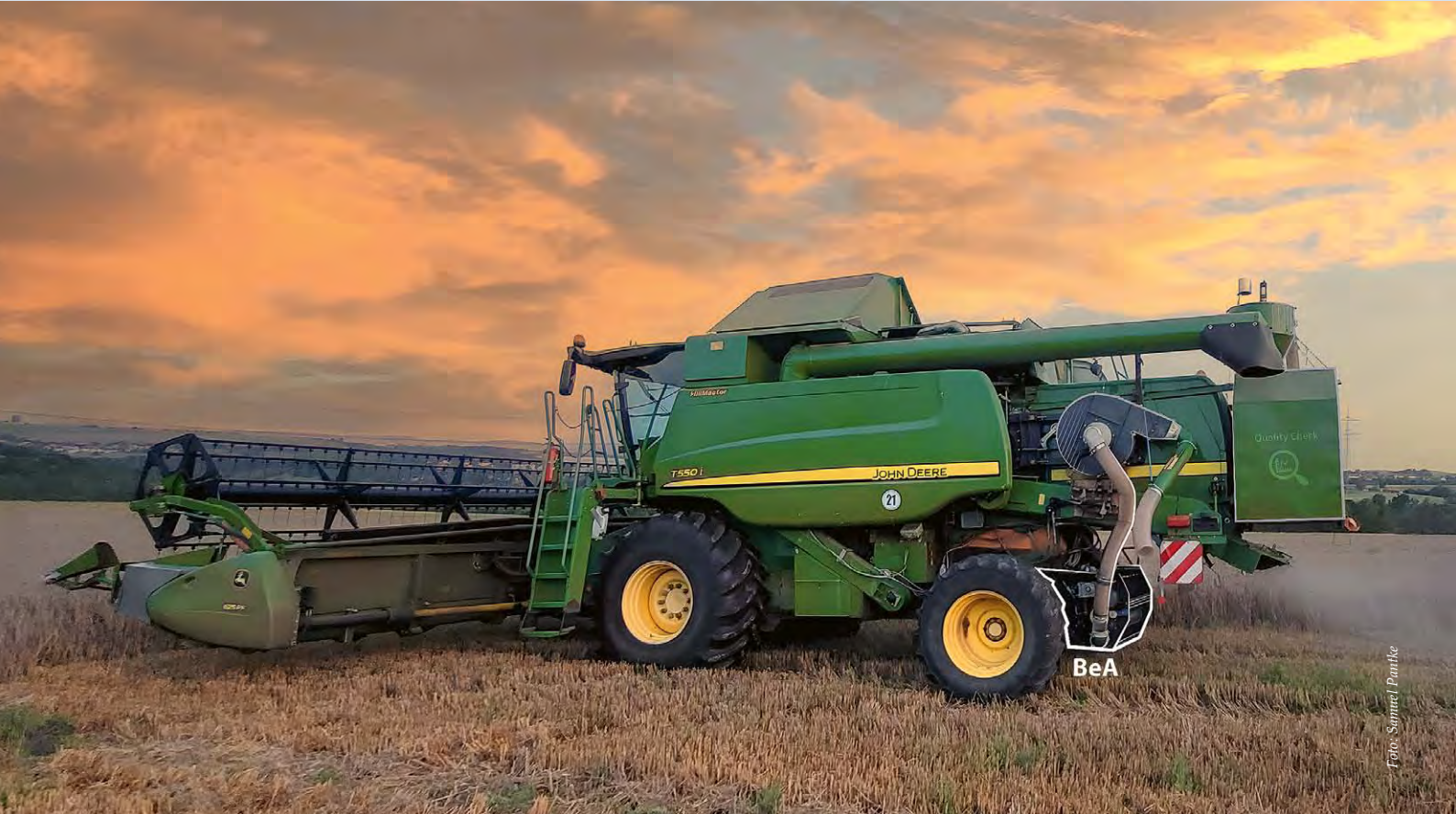
Abb. 1: Versuchsmaschine mit angebauter Abscheideeinheit, Devitalisierungseinheit und Auswertetechnik.
