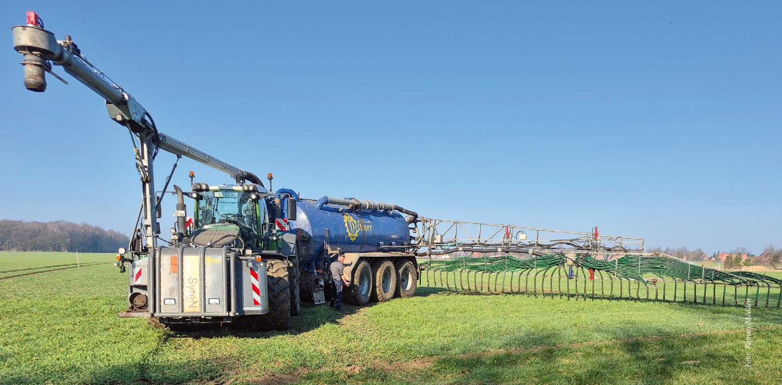
Abb. 1: Gärrestausbringung mit dem SyreN-System auf einer Demonstrationsanlage nahe Stadthagen im Rahmen des MuD Säure+ im Feld.
