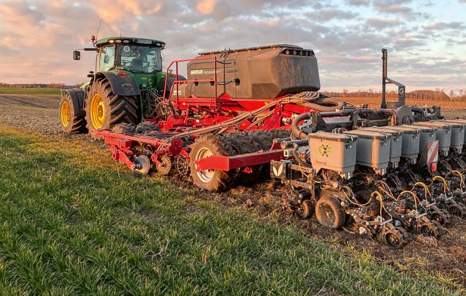
Einzelkornsämaschine von Precision Planting bei der Maisaussaat, in Kombination mit Horsch Focus.
