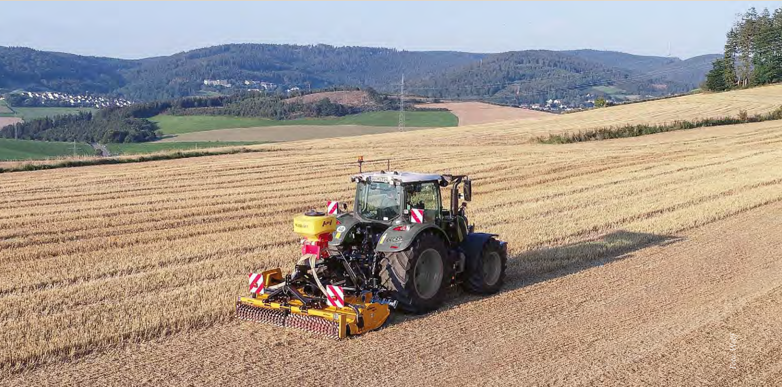
Abb. 1: CoverSeeder auf der Stoppel, Mulchen und Zwischenfruchtsaat in einer Überfahrt.
