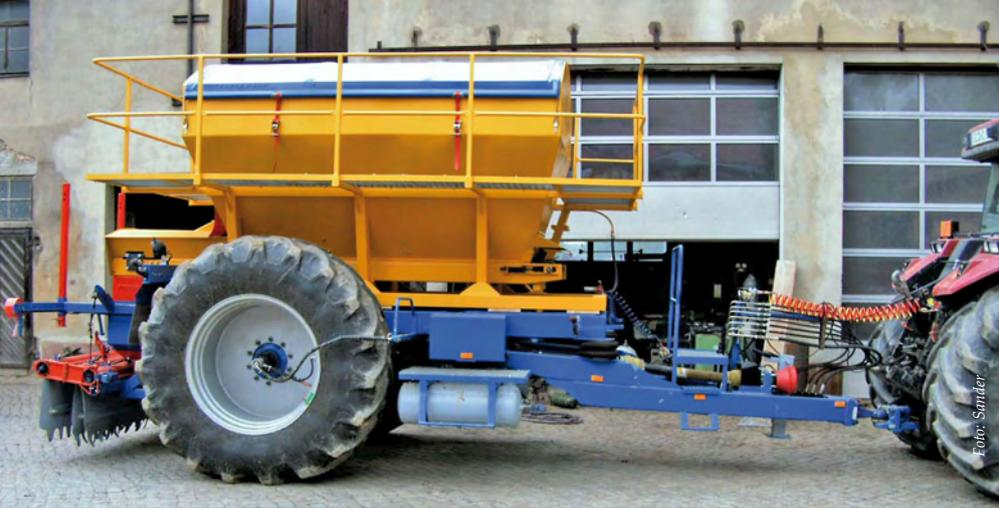
Umgebauter Kalkstreuer, ausgerüstet mit Reifendruckregelanlage.
