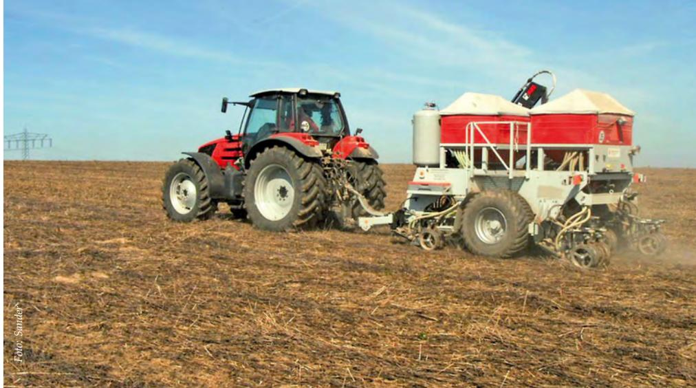
Cross-Slot-Direktsaatmaschinen mit drei Tanks für Saatgut, Unterfußdüngung sowie einer Box für Grassamen bzw. Schneckenkorn.
