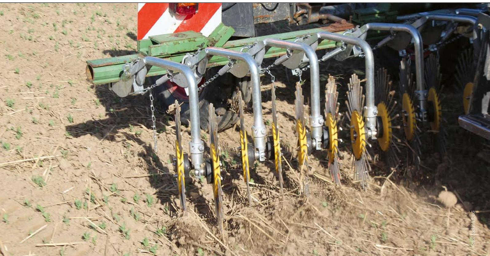
Abb. 1: Rollstriegel im Versuchseinsatz
