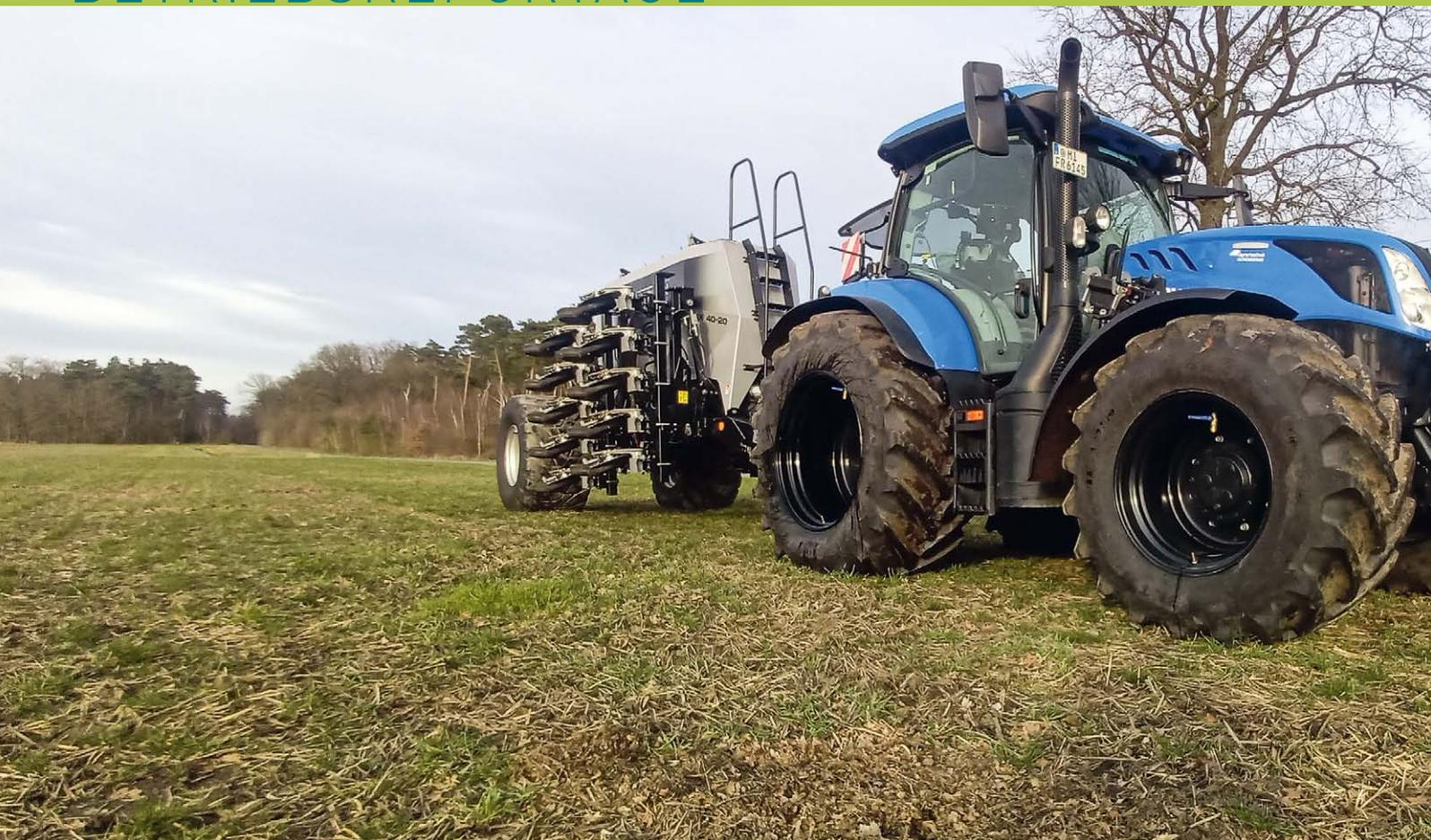
Durch den Unterschnitt benötigt die Direktsaatmaschine von Horizon Agriculture weniger Schardruck zum Ablegen des Saatgutes.
