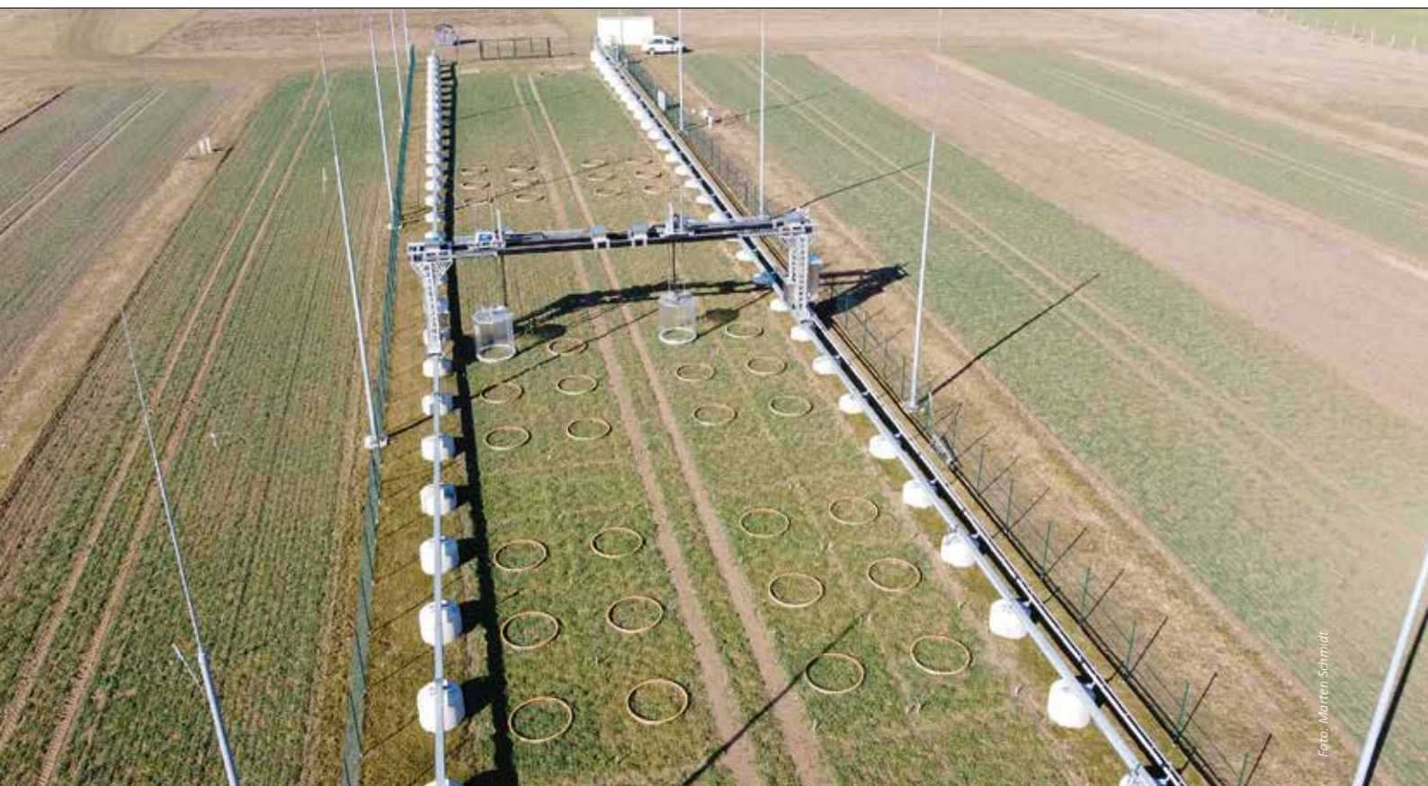
Abb. 1: Der Portalkran im ZALF-Landschaftslabor „AgroScapeLab Quillow“ (Uckermark) mit automatischen Hauben zur Messung der Treibhausgasflüsse in drei Blöcken mit Böden unterschiedlichen Erosionsgrades (Fruchtfolge 2020–23: Grünroggen-Raps-Triticale).
