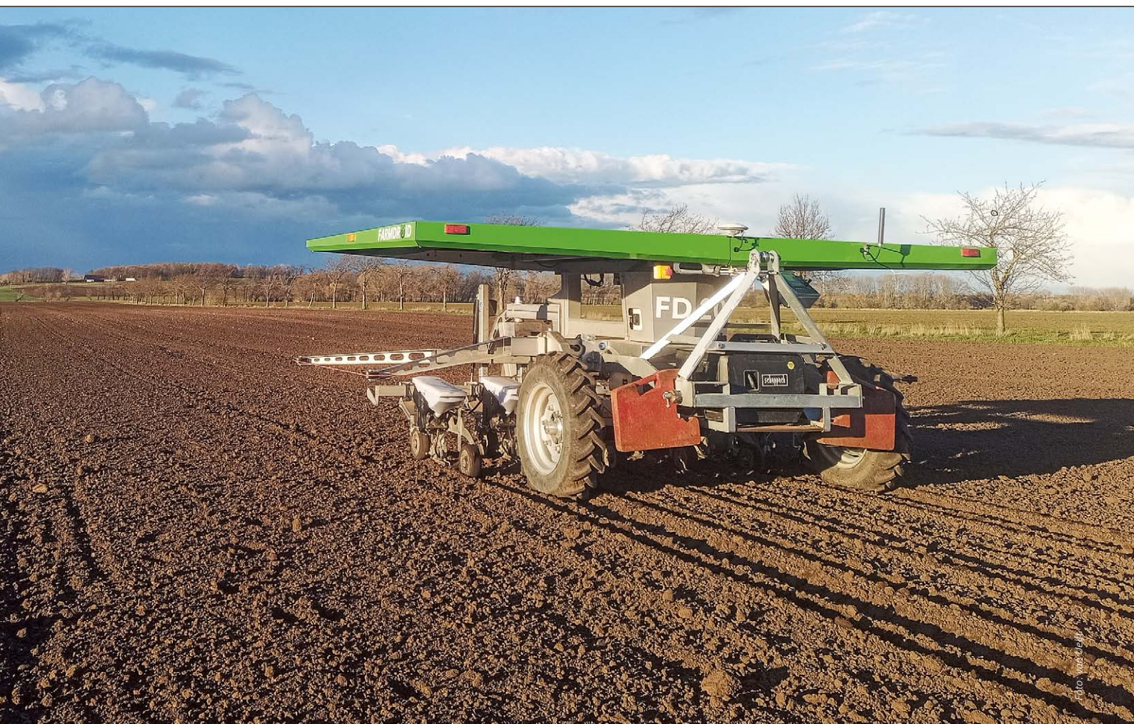
Aussaat der Zuckerrüben mit dem Farmdroid-Feldroboter
