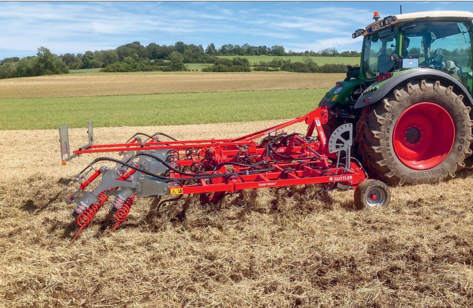
Großfederzahneggen wie die Guttler SuperMaxx BIO enterden die Queckenrhizome und legen sie zum Vertrocknen an der Bodenoberfläche ab.
