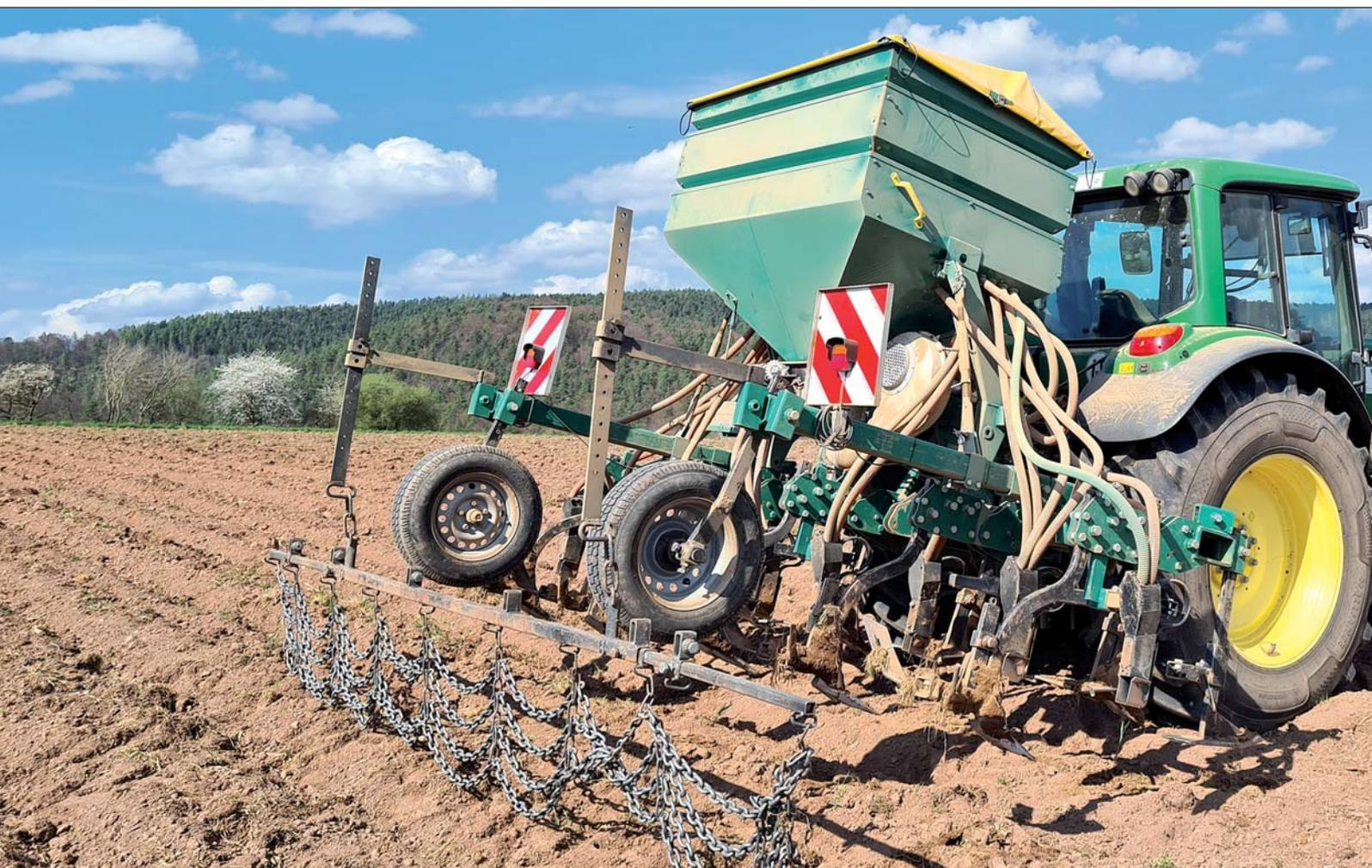
Sätechnik: Dammkulturgerät von Turiel mit aufgebautem Accord-Sätank.
