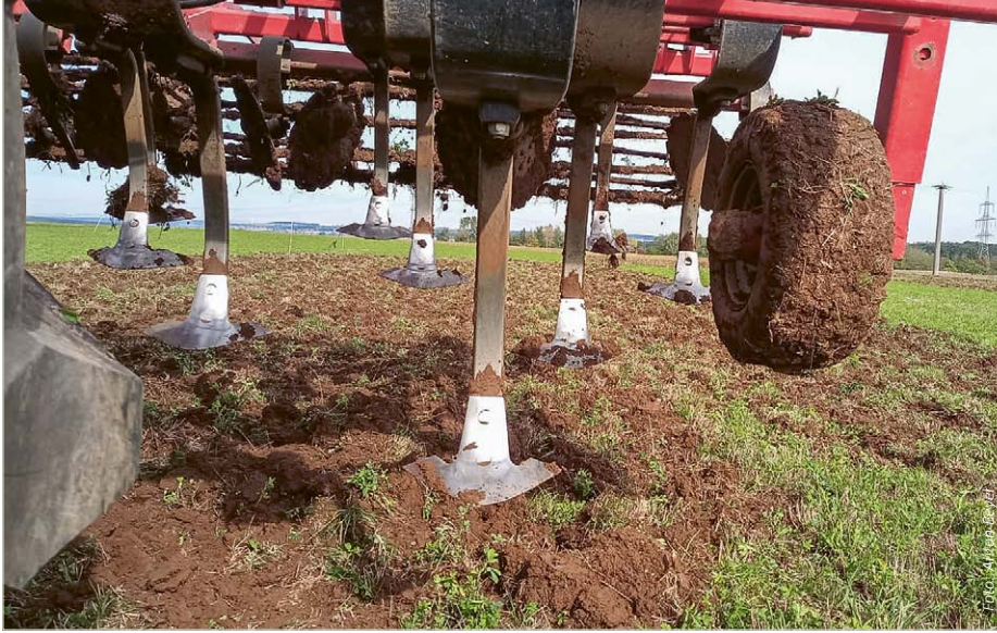
Abb. 2: Erste Bodenbearbeitung mit einem Flachgrubber mit Gänsefußscharen.
