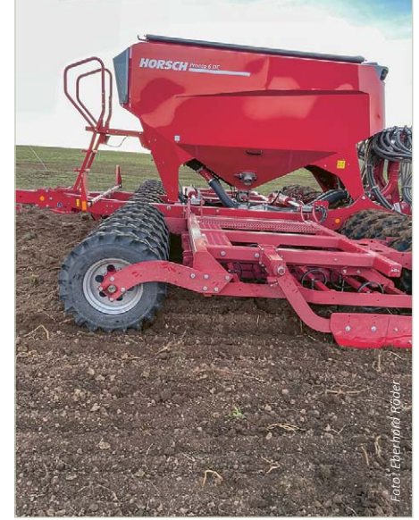
Abb. 3: Horsch Pronto DC mit vorlaufendem Federzinkenfeld zum Einbrennen und zur Herstellung von Feinerde.
