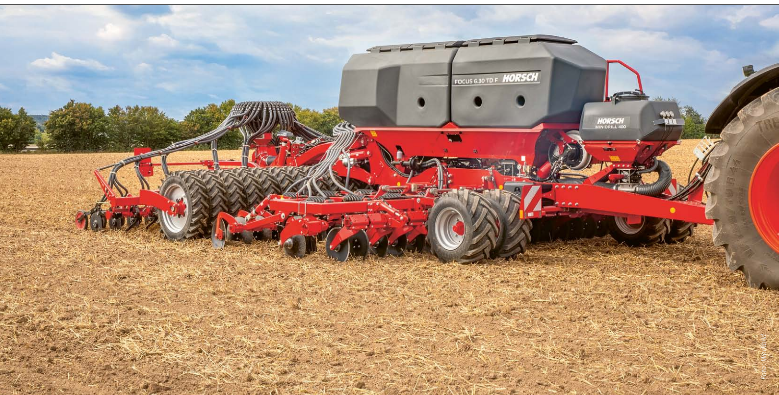
Säkombination Horsch Focus TD mit geteiltem Saattank und Zusatztank für Beisaaten (vorn).
